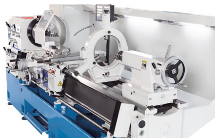
Lünette mit großem Spanndurchmesser gehört zum Standardzubehör, Abb. mit Optionen
